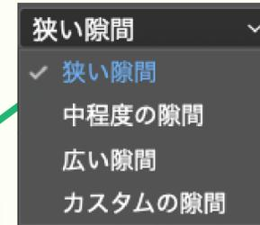
隙間として認定する幅を設定します。狭い (3px)・中程度 (6px)・広い (12px)・カスタムがありますが、カスタムにすると 0.01~72px の範囲で設定することができます。
